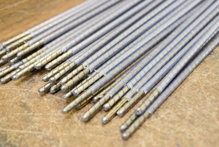
Spiralförmige Flachdraht-Armierung und querschnittsgleiche PTFE-Beschichtung zur Optimierung der Gleitreibung gehören zu den entscheidenden Qualitätsmerkmalen der Druck-Zug-Kabel-Serien 280 und 380 von RINGSPANN RCS.
