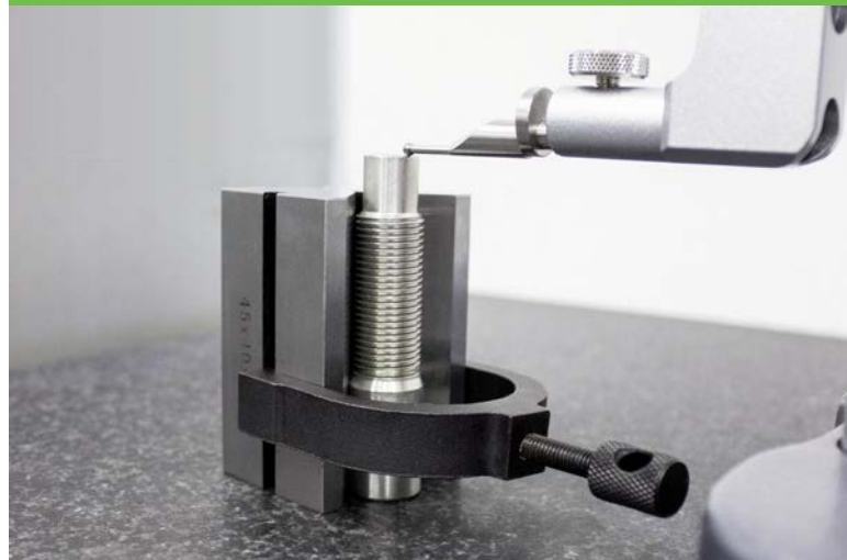
Die Qualitätssicherung ist ein zentraler Faktor in der Mechanikkabel-Produktion von RINGSPANN RCS. Das Bild zeigt die Vermessung einer Schlauchhülse.
