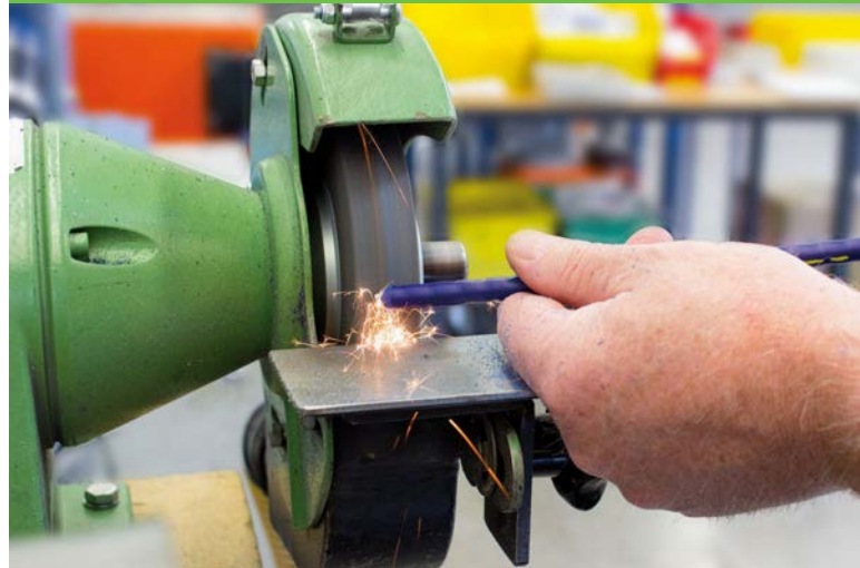
Blick in die Produktion: Das manuelle Entgraten gehört zu den entscheidenden Qualitätsfaktoren in der Druck-Zug-Fertigung von RINGSPANN RCS. Einige andere Hersteller lassen diesen Prozessschritt aus Kostengründen entfallen.
