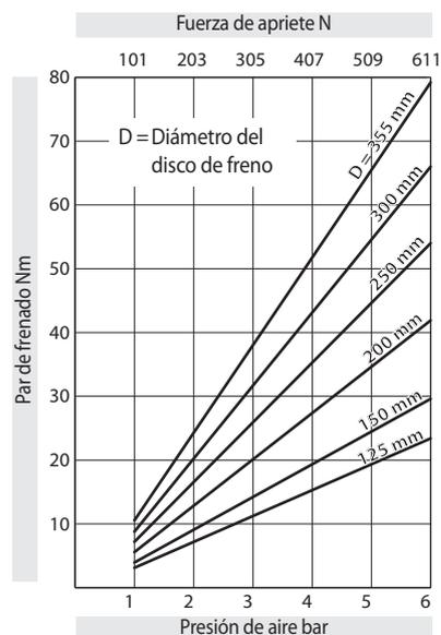
Los pares de frenado que se muestran en el diagrama se basan en un coeficiente de fricción teórico de 0,4.
