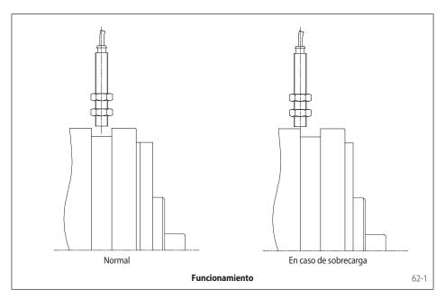
La señalización de una sobrecarga en los Limitadores SIKUMAT®, se puede indicar a través de un final de carrera sin contacto. Este se activa por un desplazamiento axial del Limitador. Por medio de cual se puede ordenar electronicamente el paro de la instalación o bien dar lugar a una señal de aviso.
